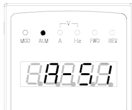
Основной/дополнительный канал частоты
